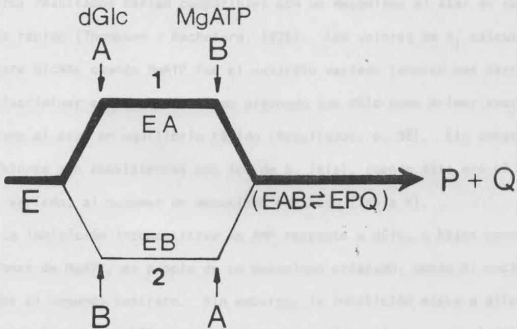
Esquema 11. Secuencia de adición de los sustratos a la glucocinasa. La vía 1 indica la ruta principal de adición de los sustratos a la enzima. El significado de las abreviaturas se encuentra descrito en el texto.
