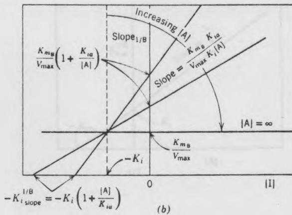
Figura A-2. Diagramas de inhibición de punto muerto para un mecanismo en secuencia ordenada Bi Bi, donde I se combina con E. (a)  $1/v$  en función de  $1/[B]$ . (b) Pendientes en función de la concentración del inhibidor.
