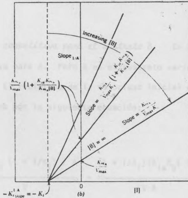
Figura A-1. Diagramas de inhibición de punto muerto para un mecanismo en secuencia ordenada Bi Bi, donde el inhibidor (I) se combina con la enzima libre (E). (a)  $1/v$  en función de  $1/[A]$ . (b) Gráfico secundario de las pendientes en función de la concentración del inhibidor. Los diagramas de las figuras A-1 a A-4 fueron tomados desde las páginas 774 a 778 del libro *Enzyme Kinetics* de I. Segel (Wiley Interscience Publication, 1975).
