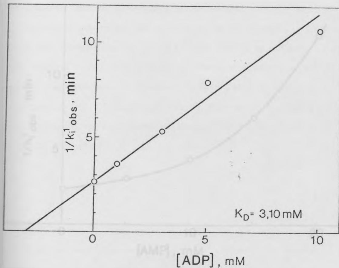
Figura 25. Efecto de la concentración de ADP sobre la constante de velocidad de inactivación por DTNB. Se inactivaron 90 mU de glucoquinasa por experimento según la metodología descrita en la figura 23.
