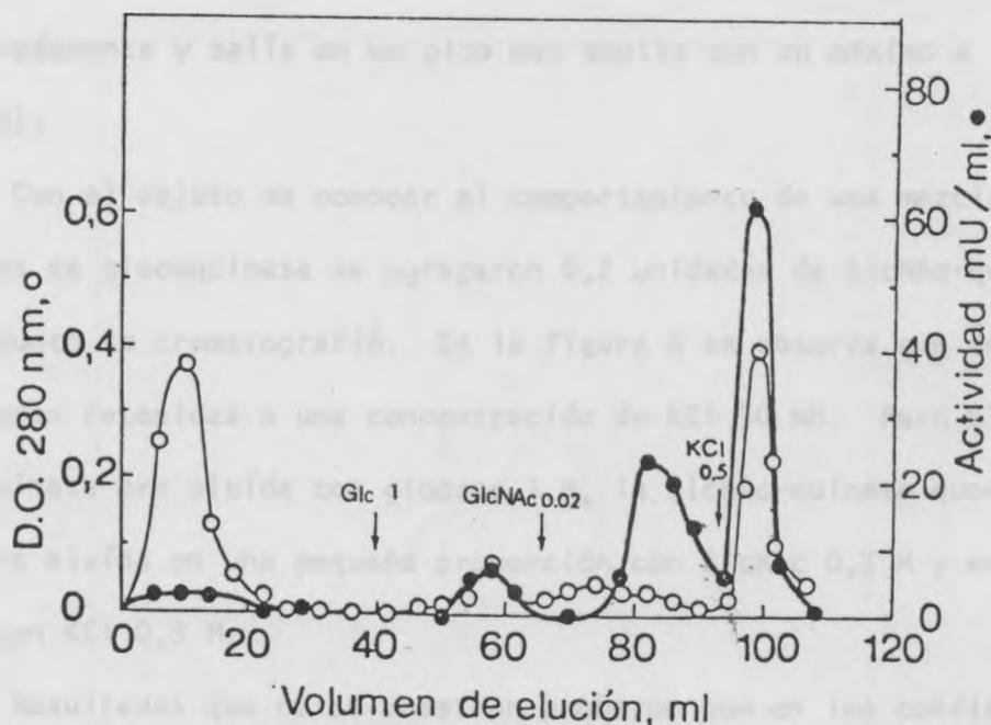
Figura 4. *Cromatografía de GlcNAc-quinasa en Sefarosa III.* 0,5 unidades de GlcNAc-quinasa (actividad específica 0,26 U/mg de proteína) en 8,5 ml de solución A (ver figura 1) conteniendo KCl 50 mM fueron cromatografiadas en una columna de Sefarosa III, equilibrada con la misma solución. Glucosa 1 M, GlcNAc 0,02 M y KCl 0,5 M se incluyeron en la solución de equilibrio como eluyentes, donde se indica.
