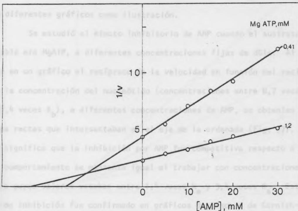
Figura 36. Gráfico de Dixon para la inhibición de glucoquinasa por AMP cuando MgATP es el sustrato variable. Las condiciones experimentales son similares a las descritas en la figura 27. La concentración de AMP varió en un rango de 0 a 30 mM y la concentración de 2-desoxiglucosa se mantuvo fija en 180 mM.
