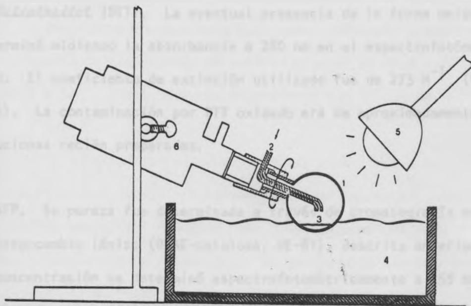
Esquema 1. Sistema para la fotooxidación. Las partes del sistema son las siguientes: 1. Matraz de reacción (15 ml); 2. Conexión al exterior; 3. Solución reaccionante; 4. Baño con hielo fundente; 5. Fuente luminosa (150 watts); 6. Motor de evaporador rotatorio.
