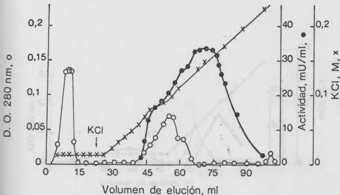
Figura 1. Cromatografía de glucoquinasa en Sefarosa III y elución mediante un gradiente de KCl. 0,62 unidades de glucoquinasa (actividad específica 0,2 U/mg de proteína) en 7 ml de solución A (fosfato de potasio 10 mM, pH 7,0; EDTA 1 mM; 2-mercaptoetanol 10 mM) fueron cromatografiadas en una columna de Sefarosa III, equilibrada con la misma solución. La enzima fue eluída aplicando un gradiente de KCl de 0 a 0,3 M en solución A.
